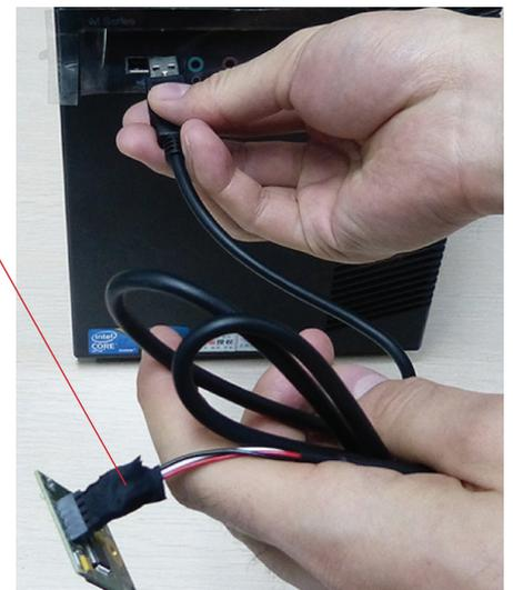
USB SSD 模块可通过适配电缆插入到普通计算机上的标准 USB 接口上作为 U 盘使用。
