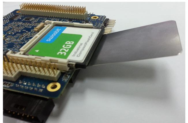
使用特定的起拔器安装和取出 Compact Flash 卡。
