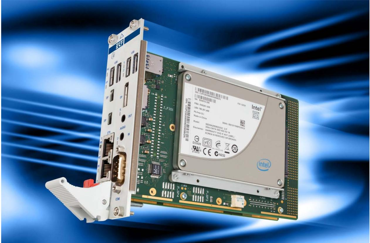
F. 安装扩展侧载板增加 USB, Audio, COM 及安装 2.5" SATA 硬盘 (C20-SATA, C32-FIO, 12HP)
