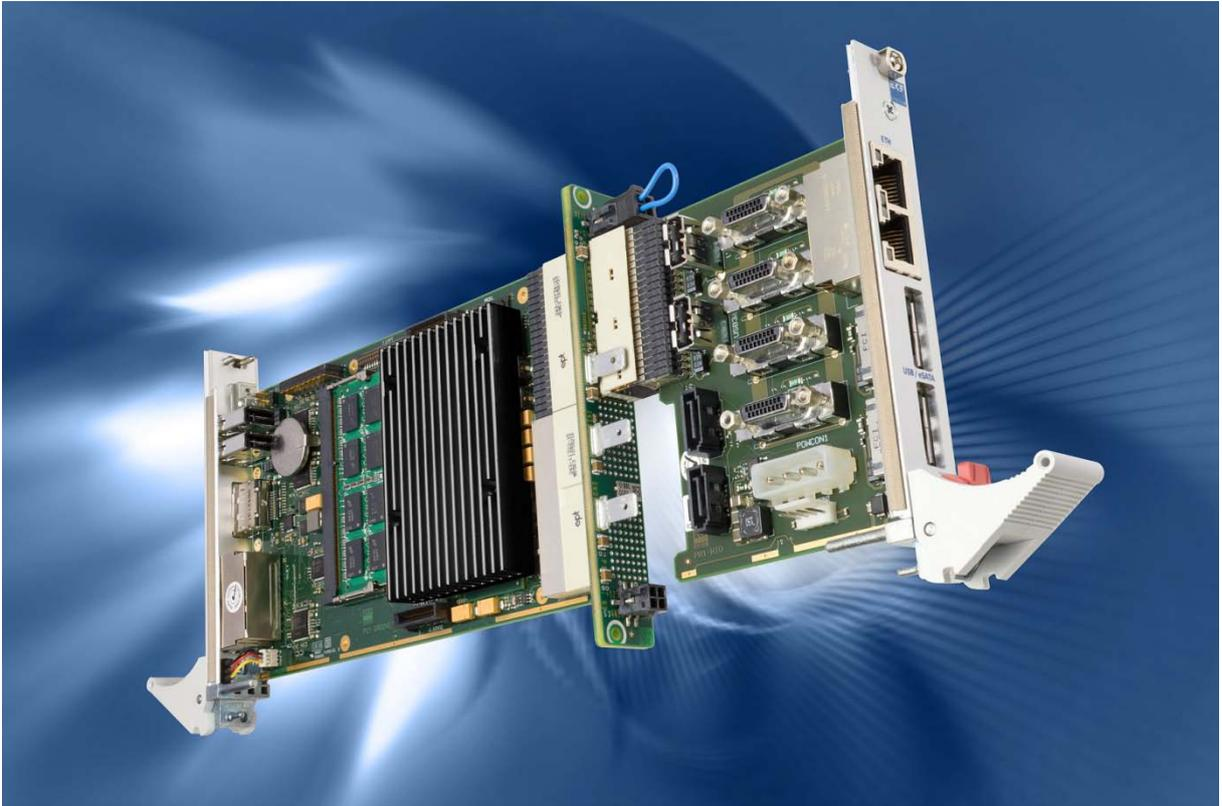
H. 配合侧载板可构成传统 cPCI 和 cPCI Serial 混合系统
