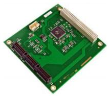
此产品将 PCIe 总线桥接转换为 PCI 总线以使 PCIe/104 系统可以支持传统的 PCI 设备(PCI-104), 也就是:将 PCIex1 转换为 4 个 32 位 PCI 负载(33/66MHz PCI),使 PCIe/104 的 CPU 可以堆叠支持 PCI-104 或 PC/104plus 外围模块.板上支持两个附加的 USB2.0 接口
