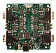
将 USB1.1/USB2.0 接口转换为 4 个串行接口,每口均支持独立支持 RS232,RS422 和 RS485 协议选择, 384 字节接收和 128 字节发送 FIFO,最大速率 921.6Kbps(RS422/485)和230.4Kbps(RS232),直接 PC/104 模式堆叠方式,无须外接附加电源.可提供 Linux, Windows 98se/ME/2000/XP/2003/Xpe 兼容的软件支持包,此支持包含有用于 Windows 基于 Visual Basic, Delphi, C++, Visual C++的样例程序和源代码,并支持第 3 方公司标准的 DLL 接口
